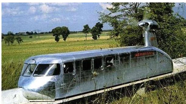
Un second rail, installé à taille réelle en 1969 sur un viaduc en béton, se dressa sur 18 km dans la Beauce, au nord d'Orléans : il a testé l'aérotrain en version "commerciale", et surtout testé les capacités du coussin d'air à
